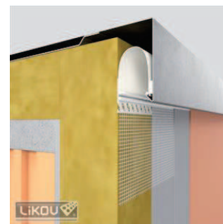
Obr. 30 Zateplení atiky; styk s klempířským prvkem PVC profilem
