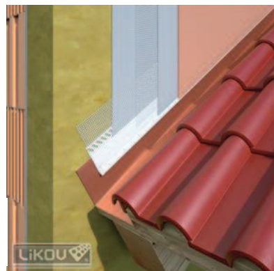
Obr. 22 Napojení oplechování parapetu a římsy na ETICS pomocí PVC profilů
