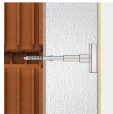
Obr. 26 Správné osazení hmoždinky - zápusťná montáž
