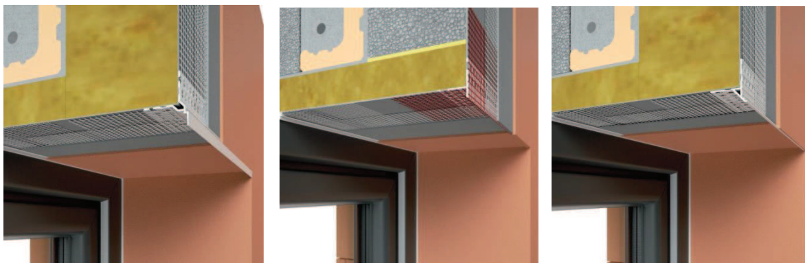
Obr. 33 Zateplení nadpraží s použitím nadpražního profilu s okapničkou
