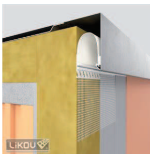
Obr. 30 Zateplení atiky; styk s klempířským prvkem PVC profilem
