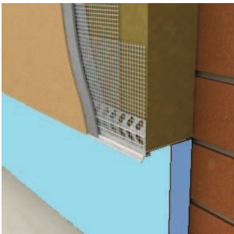
Obr. 21 Založení soklového profilu při zateplení soklu (ukončení pod terénem)
