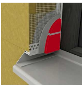
Obr. 22 Napojení oplechování parapetu na ETICS pomocí PVC profilů
