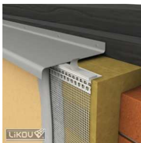
Obr. 22 Napojení oplechování parapetu na ETICS pomocí PVC profilů
