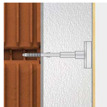
Obr. 25 Správné osazení hmoždinky - zápustná montáž
