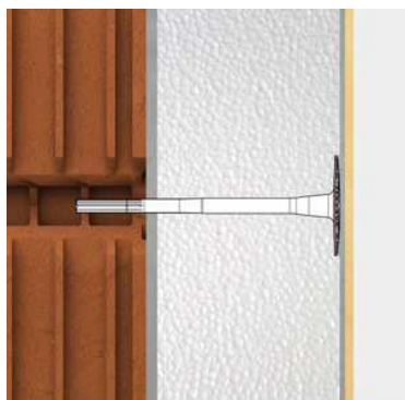
Obr. 24 Správné osazení hmoždinky - povrchová montáž
