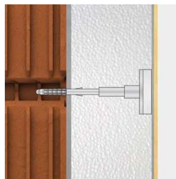
Obr. 25 Správné osazení hmoždinky - zápusťná montáž
