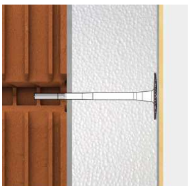
Obr. 24 Správné osazení hmoždinky - povrchová montáž
